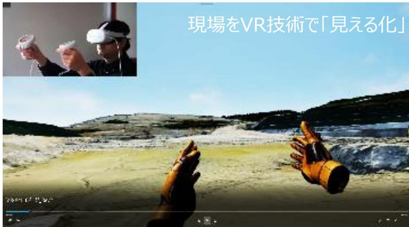
実測地形と設計データをVR技術にてモデル空間を作り、Google上に映し出したVR空間で完成検査にて試行的に出来形確認検測を行った。検測の精度を実証する必要があるため現場に人員を配置しVRでの検測点とほぼ同位置を検測して精度に問題ないか確認した。
