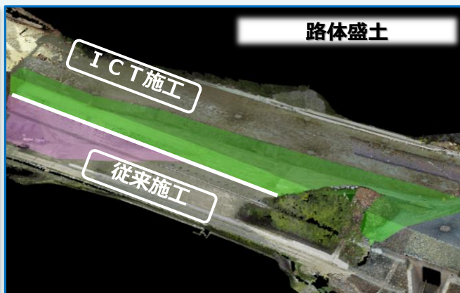
制約のある盛土箇所(工事用道路)
