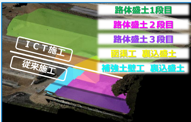
路体盛土が重なった狭隘な盛土箇所
