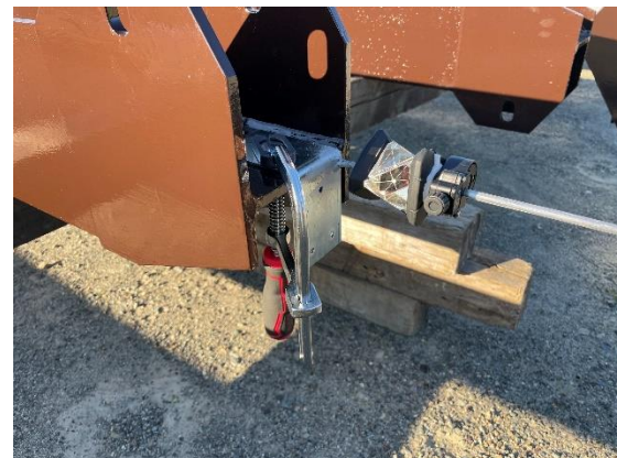
専用治具を製作し、支柱頭部へのプリズム取付
