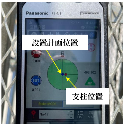
快測ナビ (ICT施工現場端末アプリ)で架設作業中に計画位置との偏芯量を確認。
