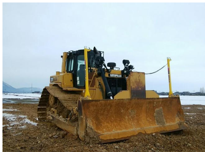
使用機械(21t級ICTブルドーザー)
