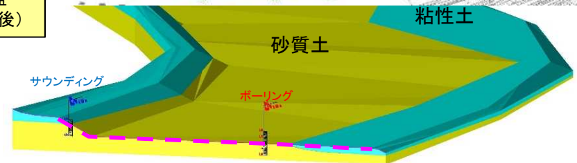
三次元地盤モデル(掘削後)
