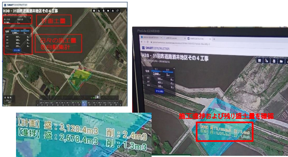
クラウド型プラットフォームシステムによる日々の施工量の把握・施工進捗確認
