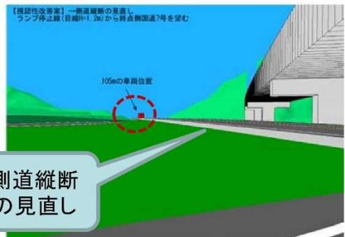
☺ IC交差点部の視認性阻害が確認されたため、各設計を見直し、停止線からの視認性を確保。
