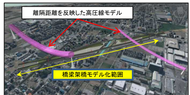
橋梁と架空線の離隔確認
