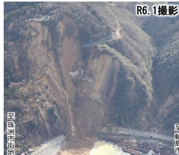
地震による道路決壊を伴う地すべり・斜面崩落
