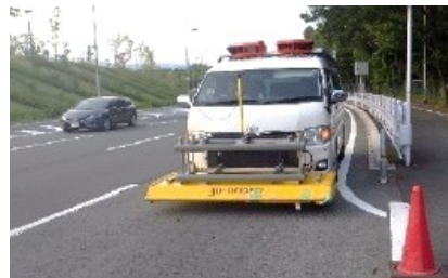
車載カメラの映像から、AIを用いて舗装の損傷を診断
