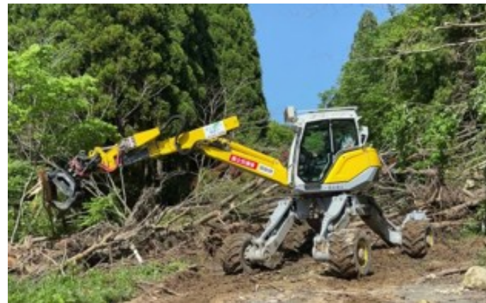
把み装置(グラップル)による倒木除去作業
