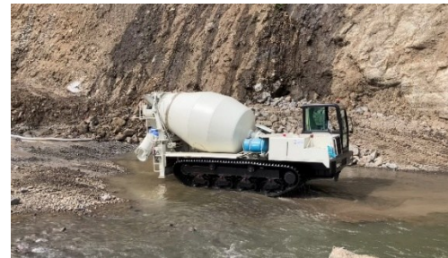
河原田川の河道内を走行しコンクリートを運搬するゴムクローラー式コンクリートミキサー車
