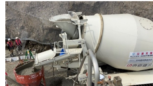
河原田川の河道内を走行しコンクリートを運搬するゴムクローラー式コンクリートミキサー車
