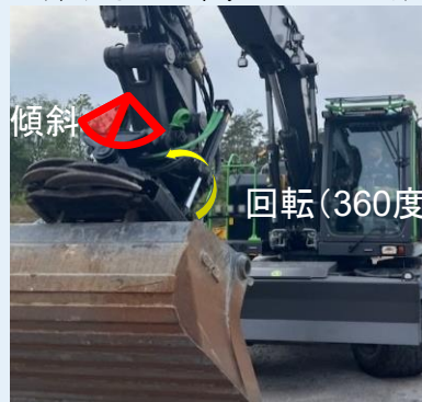
アタッチメントの傾斜(チルト)や回転(ローテーション)が可能
