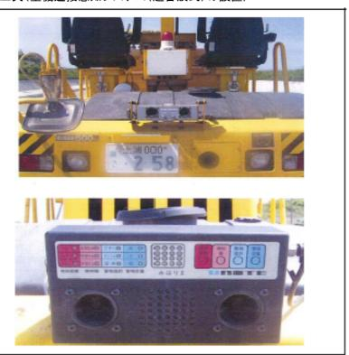
事例-4 安全仮設備等の工夫(架空線があることを気付かせる工夫)
