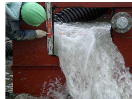
排水量の三角堰による測定状況
