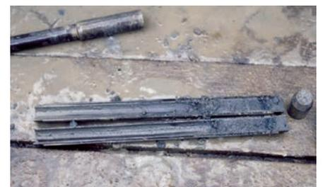
図-3 標準貫入試験試料
