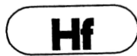
Hf形とそれ以外の蛍光灯ランプが使用可能な照明器具マーク
