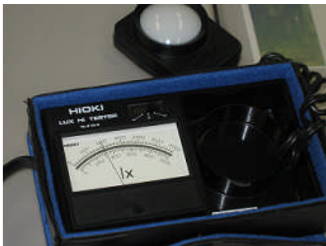
照度計測器で机上照度を計測
