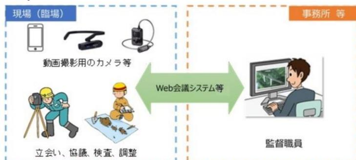
遠隔臨場の機器構成 (例)
