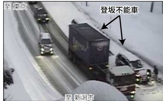
登坂不能車発生状況（湯沢町三俣）
