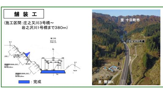
▶ 庄之又川3号橋から岩之沢川1号橋までの舗装工、排水工、防護柵工が完成しました。
