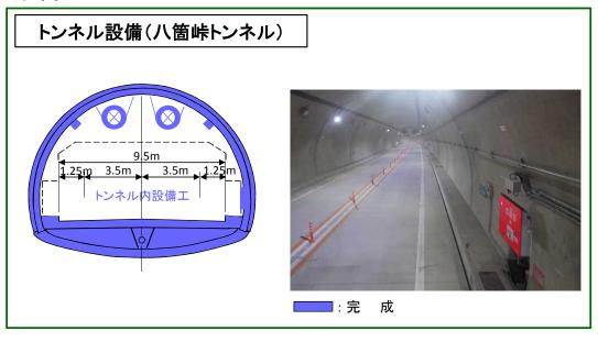
▶ トンネル内の各種設備(非常警報、照明、換気、消火栓、ラジオ再放送、受変電等)の設置が完成しました。
