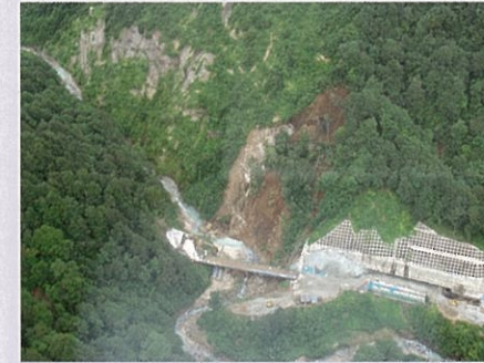
⑧7号橋梁下部その2他工事(A1橋台流出)
