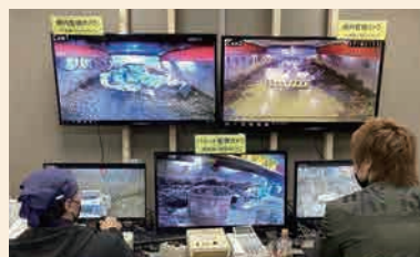
地上遠隔操作室の状況(無人掘削)
