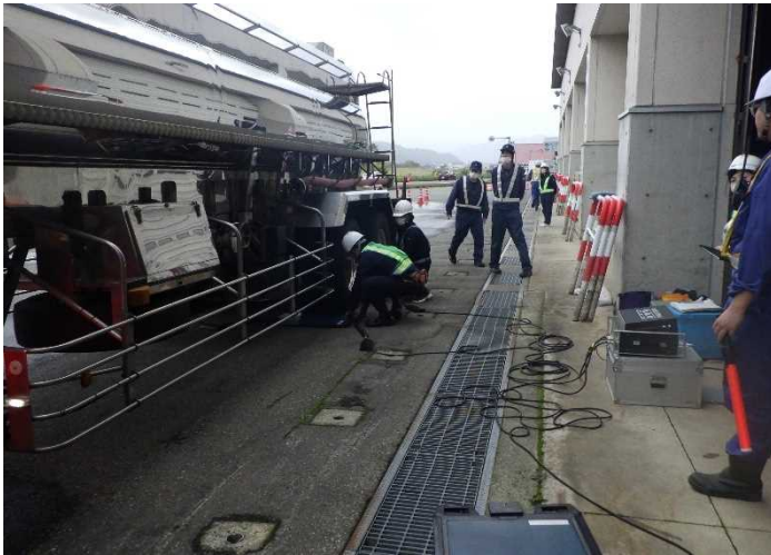
車両の重量を計測しています。
