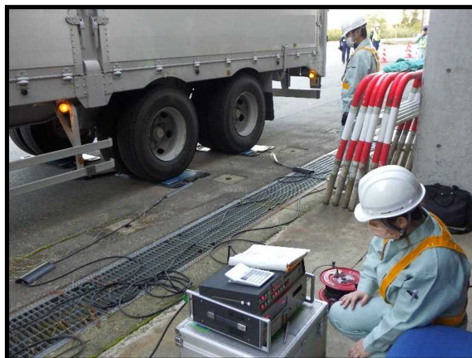
車両の重量を計測しています。
