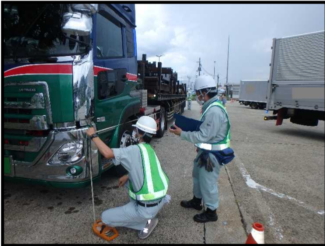
車両の寸法を計測しています。
