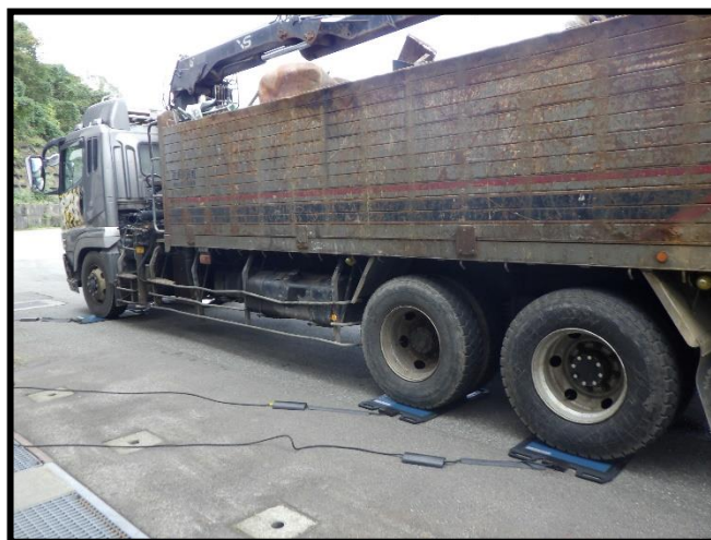
車両の重量を計測しています。
