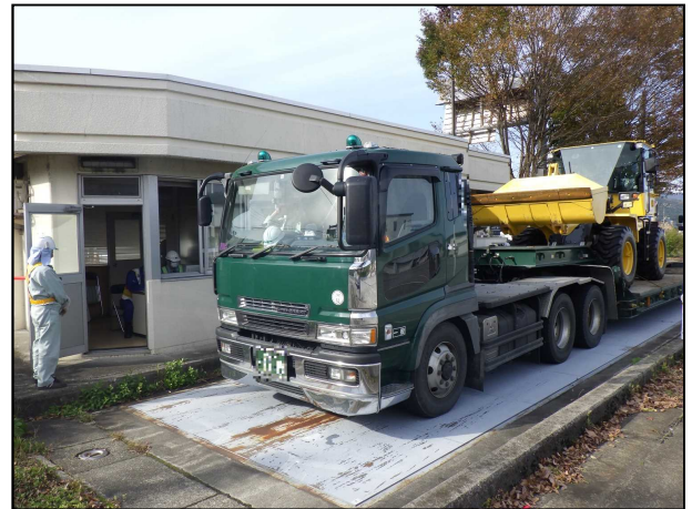
特殊車両の重量を計測しています。
