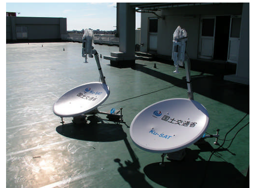
中越沖地震の際に柏崎地域振興局の屋上に設置されたKu-SAT(映像受信側)
