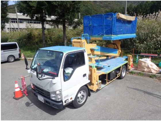
高所作業車 拡幅デッキ
