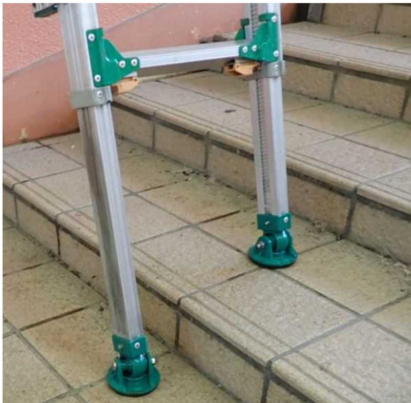
階段部での脚部の伸縮状況（拡大写真）
