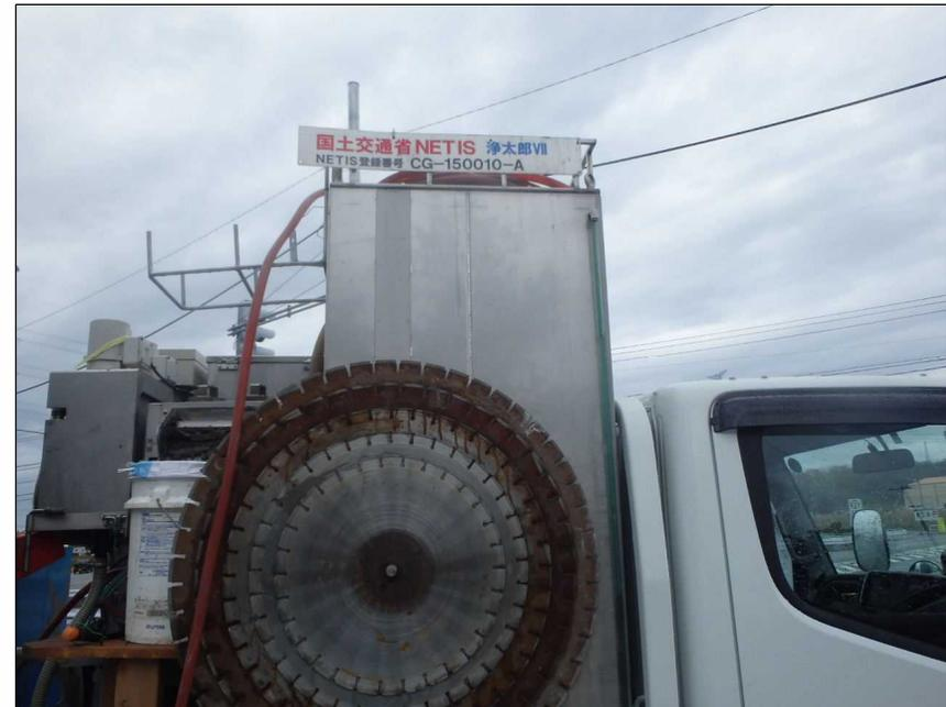
この設備を使うことにより、汚泥排水をすばやく脱水処理し、冷却水の再利用が出来、さらに産業廃棄物の削減にもつながるため、経済性の向上に努めた。
