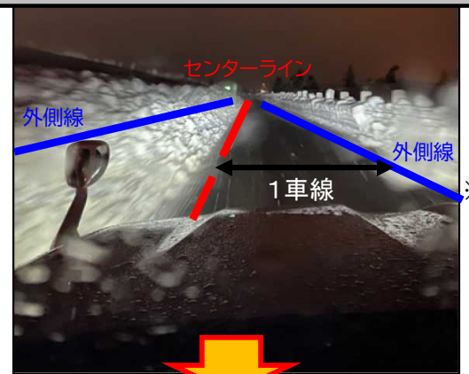
②梯団除雪では車線幅員が確保出来ない状態
