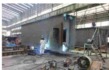
①-1 工場での鋼桁製作
