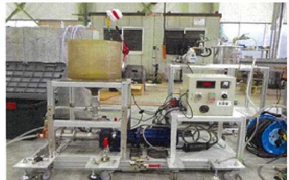
[写真-2 グラウト再注入機器1式]
