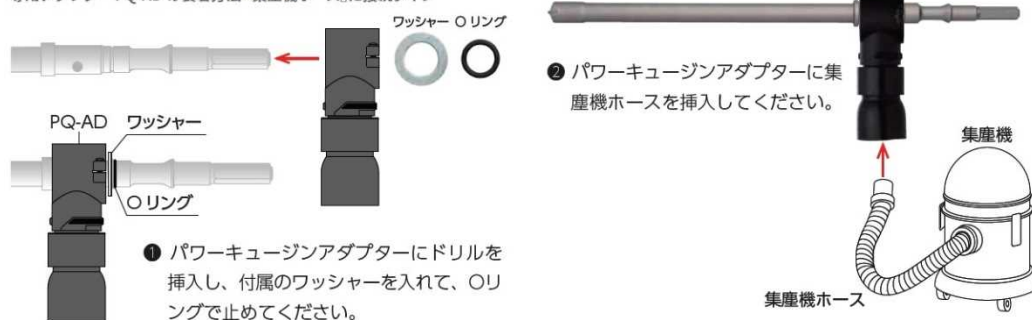
専用アダプター PQ-AD の装着方法『集塵機ホース』に接続タイプ
