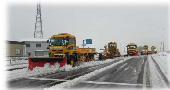
中之島除雪工区の梯団除雪の構成 (6台体制)
