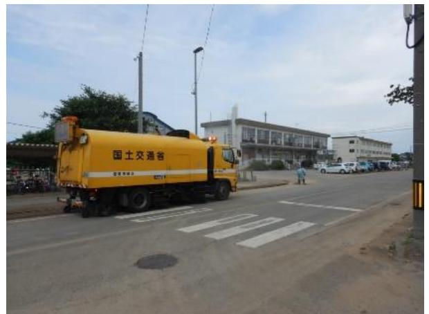
【路面清掃作業(村上市荒川地区)】
