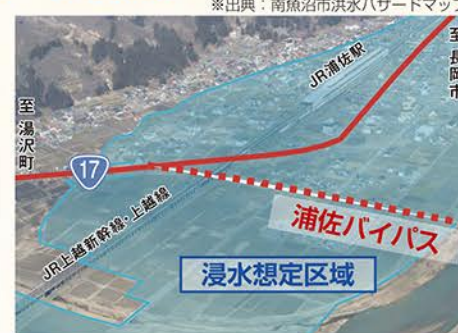
現道区間の冠水想定区域
