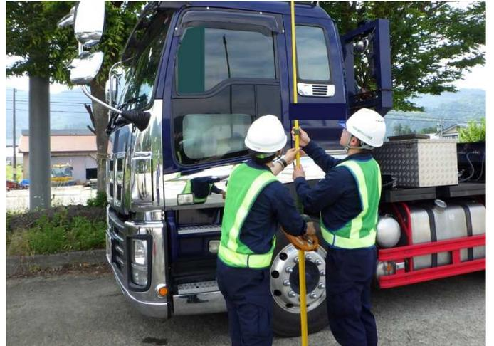
車両の寸法（高さ）を計測しています。
