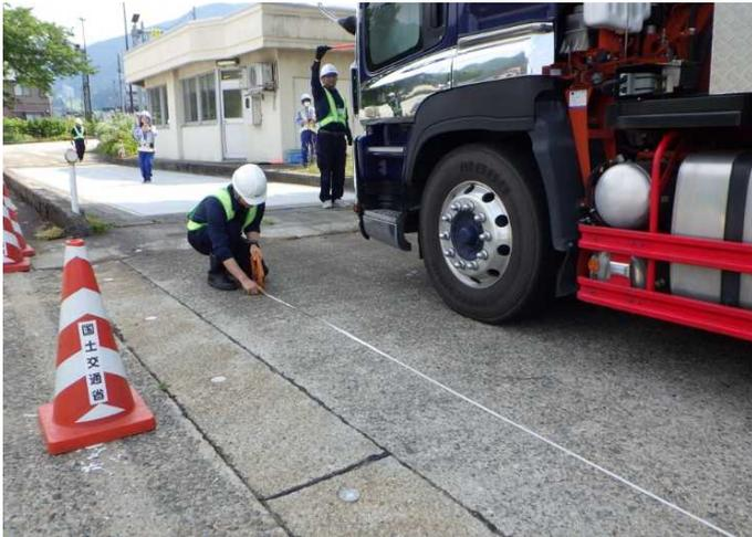
車両の寸法（長さ）を計測しています。
