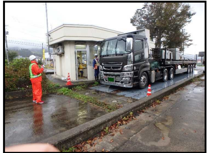
車両の重量を計測しています。
