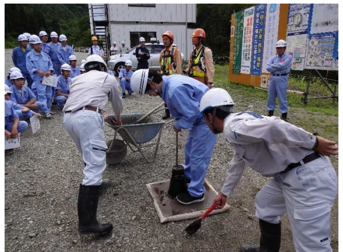
コンクリートのスランプ試験に挑戦
