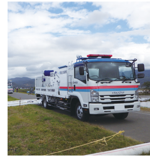
排水ポンプ車
