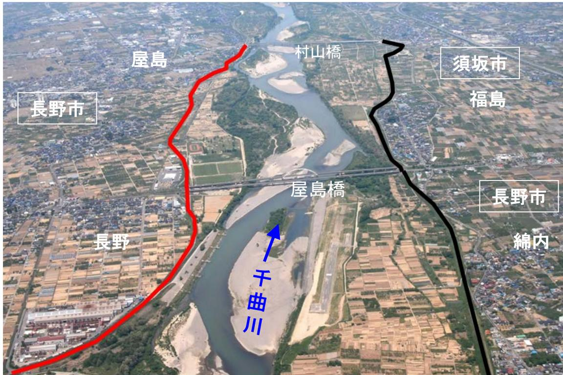
● 当該地区(長野市村山橋～落合橋間)の堤防は高さや断面が不足しているとともに、浸透に対する安全度が低く、洪水により堤防が決壊した場合、甚大な被害が発生するおそれがある。
