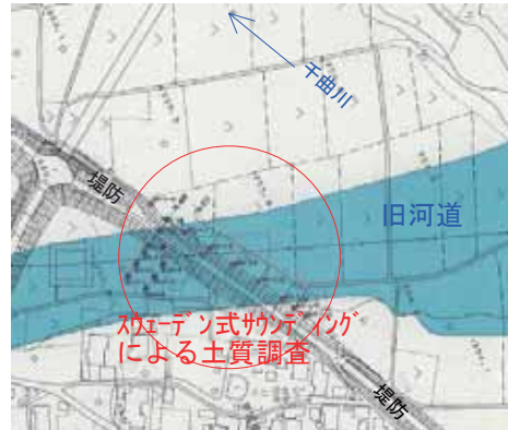
図－8 旧河道と面的な土質調査
