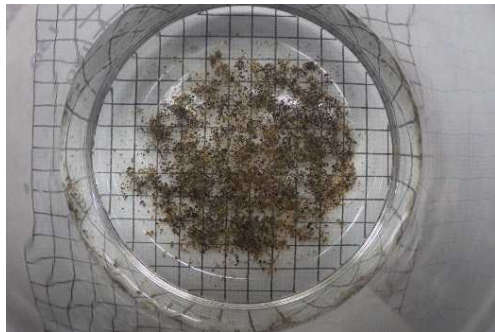
回収した掃流砂（土砂投入後：平瀬②）
