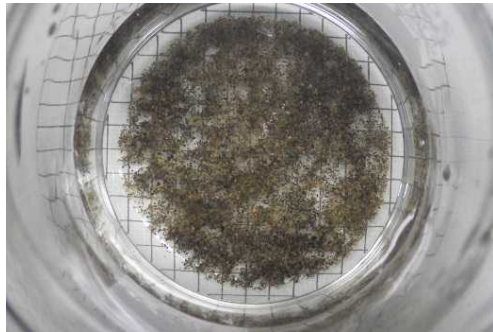
回収した掃流砂（土砂投入前：平瀬②）
