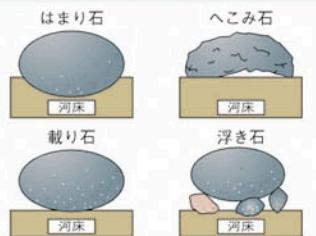
はまり石：石の下の部分が底質に埋没して、上だけが水中に出ている
