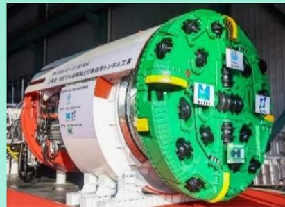
TBM工法 (トンネルボーリングマシン)
