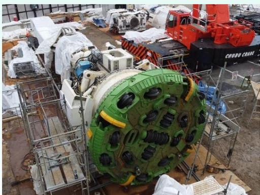
TBMマシン組み立て状況
