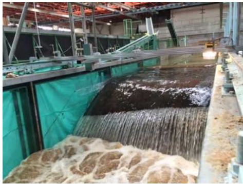
越流実験状況
