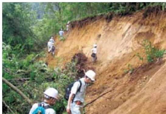
写真3-8-3 地すべり上部、滑落崖の確認
