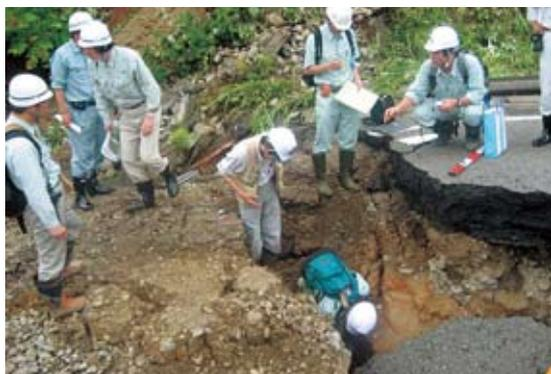
写真3-8-2 道路を寸断した亀裂箇所の調査
