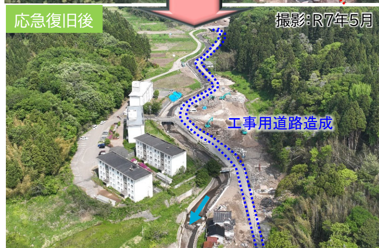
塚田川沿川での土砂流出及び工事用道路整備状況
