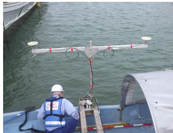
測深機器艀装確認状況
